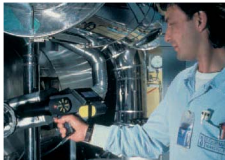
Travailleur du nucléaire effectuant une mesure de contrôle en radioprotection.
